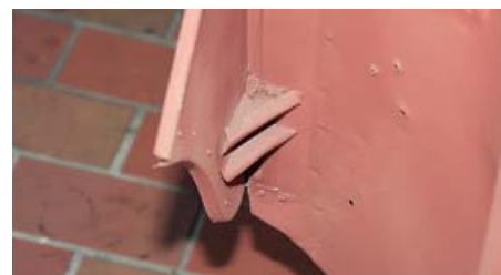
1959er Karosseriemerkmale: das Dreiecksblech vor der A-Säule hat kein Innenblech, die...
